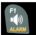
Im Flug ist es möglich, jeden Alarm mit einem Langdruck auf die **Taste Alarm** → Sensor x, mit der Taste F1, ein- oder aus zu schalten.
