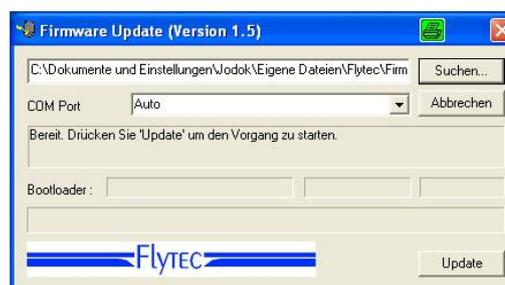
Bei der Sicherheitswarnung drücken Sie auf **Ausführen**, danach startet das Programm. Verbinden Sie nun das USB-Kabel mit dem Gerät. Danach können Sie im Feld Com Port die Schnittstelle einstellen oder wenn Sie es nicht wissen, auf **Auto** stellen und automatisch suchen lassen. Die virtuelle COM Schnittstelle sollte zwischen 1 und 9 liegen. Darüber kann der Flasher die Schnittstellen nicht mehr erkennen.
