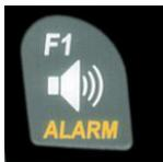
Im Flug kann der Stall Alarm mit einem Langdruck auf die **Taste Alarm** → Stall mit den Tasten F1 ein- oder ausgeschaltet werden.
